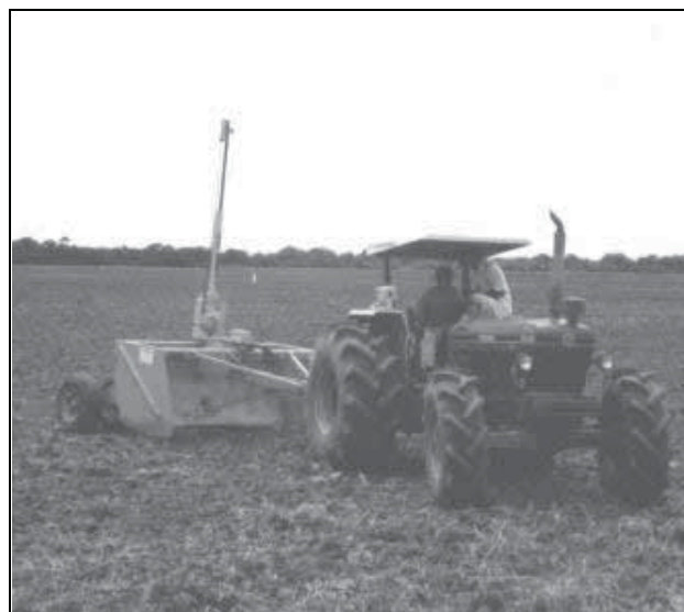
Laser gestuurde landegalisatie equipment getrokken door een trekker
