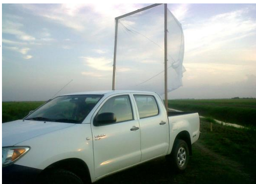
Foto 2: Vangnet bevestigd op de bak van de terreinwagen.
